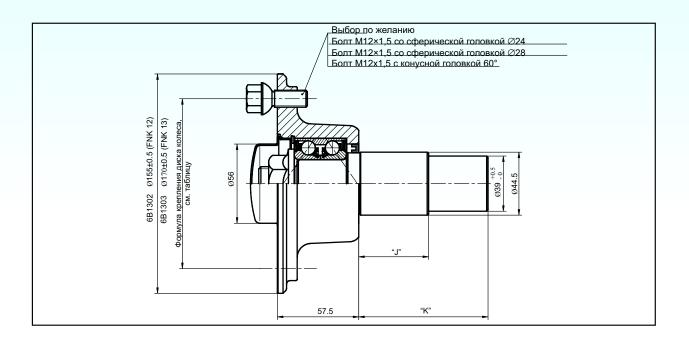
Максимальная нагрузка на ступицу: Максимальная нагрузка на ось: ЕТ-глубина установки диска колеса при нагрузке на ось до 450 kg от 451 kg
