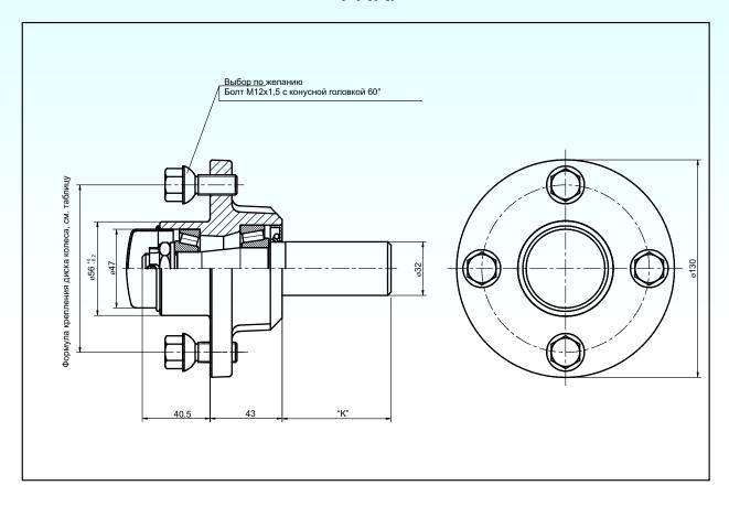
Максимальная нагрузка на ступицу: Максимальная нагрузка на ось до 500 kg: ET-глубина установки диска колеса
