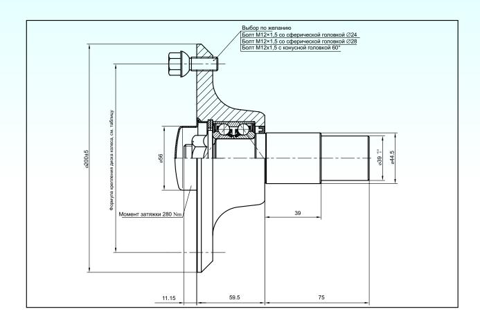
Максимальная нагрузка на ступицу: Максимальная нагрузка на ось: ЕТ-глубина установки диска колеса при нагрузке на ось до 800 kg от 801 kg 750 kg 1500 kg 0-45 mm 26-35mm
