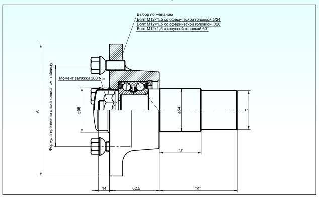
Максимальная нагрузка на ступицу: Максимальная нагрузка на ось: ЕТ-глубина установки диска колеса при нагрузке на ось до 750 kg от 751 kg
