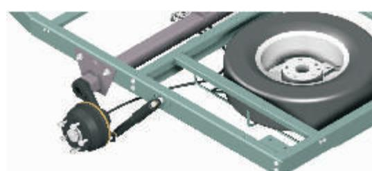
Амортизатор можно установить сзади
