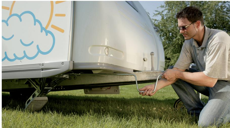
Винтовая опора AL-KO обладает максимальной несущей способностью только тогда, когда ее опорная часть находится под углом  $45^\circ$ . При других углах наклона опорной части (например:  $30^\circ$ ,  $60^\circ$ ) несущая способность винтовой опоры значительно снижается (см. чертеж).
