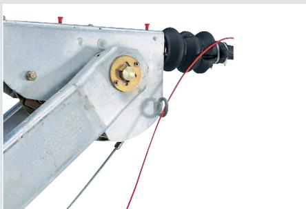
Усилие передается непосредственно через трос и тягу. Тем самым мы достигаем передачи усилия лишь с малыми потерями на трение. Это повышает тормозное усилие и сокращает тормозной путь.
