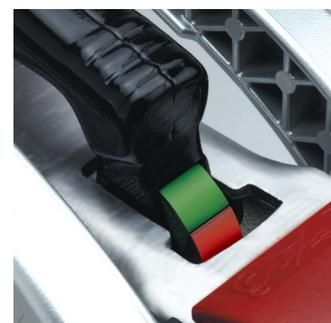
Индикатор износа фрикционной накладки (передней и задней), а также механизма замкового устройства.
