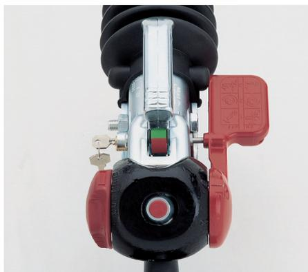
Устройство AKS™ 1300 можно дооснастить съемным страховочным замком. Такая мера предосторожности предотвращает кражу как прицепа, так и самого устройства AKS™ 1300.
