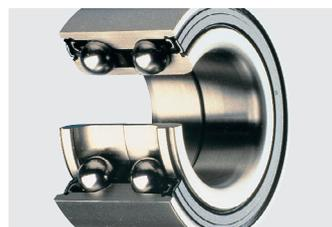
Автомобильный подшипник, двухрядный, шариковый, с наклонными дорожками; не требует технического обслуживания; предусмотрена регулировка натяга подшипника.
