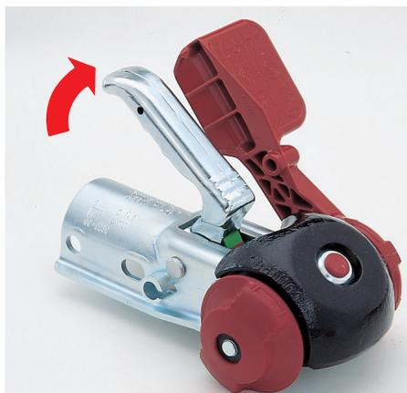
Когда AKS™ 1300 еще не соединен со сцепным шаром TCU, рукоятка замкового устройства (ЗУ) находится в положении «ОТКРЫТО».
