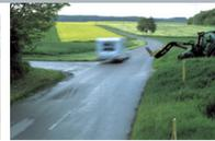
При сильных колебаниях система ATC автоматически тормозит прицеп. Торможение настолько мягкое, что водитель практически его не чувствует.
