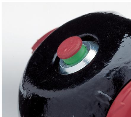
Если устройство AKS™ 1300 правильно установлено на сцепном шаре TCU автомобиля-тягача, то видна зеленая зона цилиндра индикатора безопасности.
