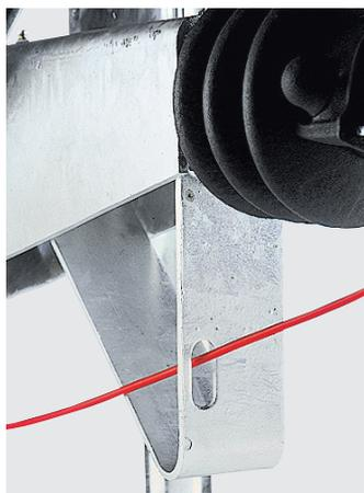
От загрязнения и повреждения замковое устройство (ЗУ) защитно-опорной скобой, а специальная направляющая обеспечивает правильный ход троса системы аварийного торможения.
