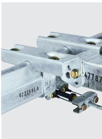
Конструкция отдельных элементов со склада позволяет собрать любые T-образные шасси. Для соединения стандартных осей с дышлами применяются специальные кронштейны. Также могут применяться и оси с приваренными кронштейнами под дышло.
