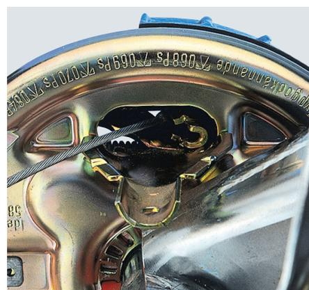
Монтаж тормозного троса в колесном тормозе
