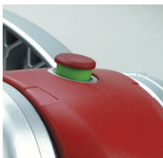
Зеленая зона цилиндра индикатора сигнализирует о правильном сцеплении ЗУ AKS™ 3004/3504 со сцепным шаром ТСУ.
