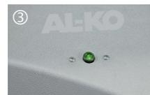
③ Горящий зеленый светодиод на корпусе тормоза наката сигнализирует о полной готовности к работе.
