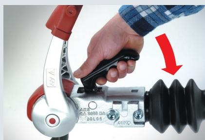
Наденьте AKS™ на сцепной шар TCU и зафиксируйте, опустив рукоятку ЗУ в горизонтальное положение (шар должен быть чистым и без следов смазки).
