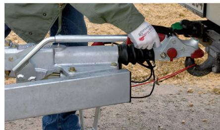
**Положение «закрыто».** Если виден зеленый цилиндр индикатора, то это означает, что **замковое устройство правильно соединено со сцепным шаром!** Рукоятка теперь направлена горизонтально.
