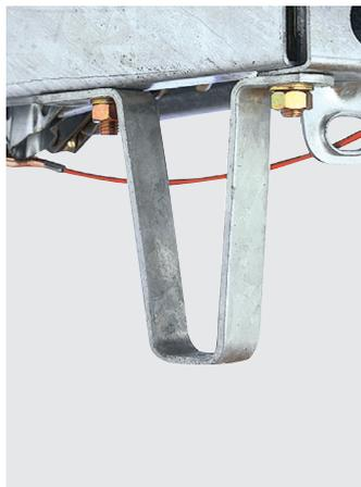
Опорная скоба защищает замковое устройство (ЗУ) от повреждения и загрязнения при контакте с дорогой. Дополнительно предусмотрен трос системы аварийного торможения на случай отрыва прицепа от тягача. Он гарантирует правильную работу аварийного тормоза.
