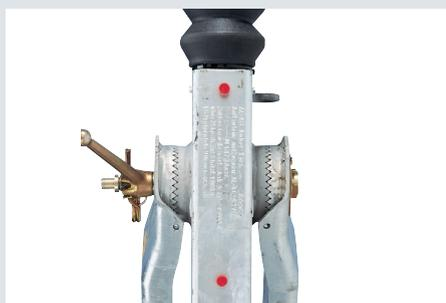
Дополнительные зубчатые шайбы в местах соединения, испытывающих сильные нагрузки, удваивают число зубьев, что дает большое преимущество по сравнению с традиционными зубчатыми головками. Именно благодаря соединению с геометрическим замыканием, тормоза наката отличаются своей прочностью и долгим сроком службы.
