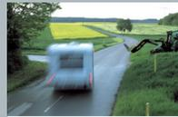
Автопоезд заносит. Датчики ATC регистрируют боковые колебания (ускорения) прямо на оси прицепа.
