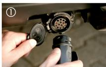
① Подвод электропитания от легкового автомобиля обеспечивается 13-ти полюсным штекером (не 7-ми полюсным!)
