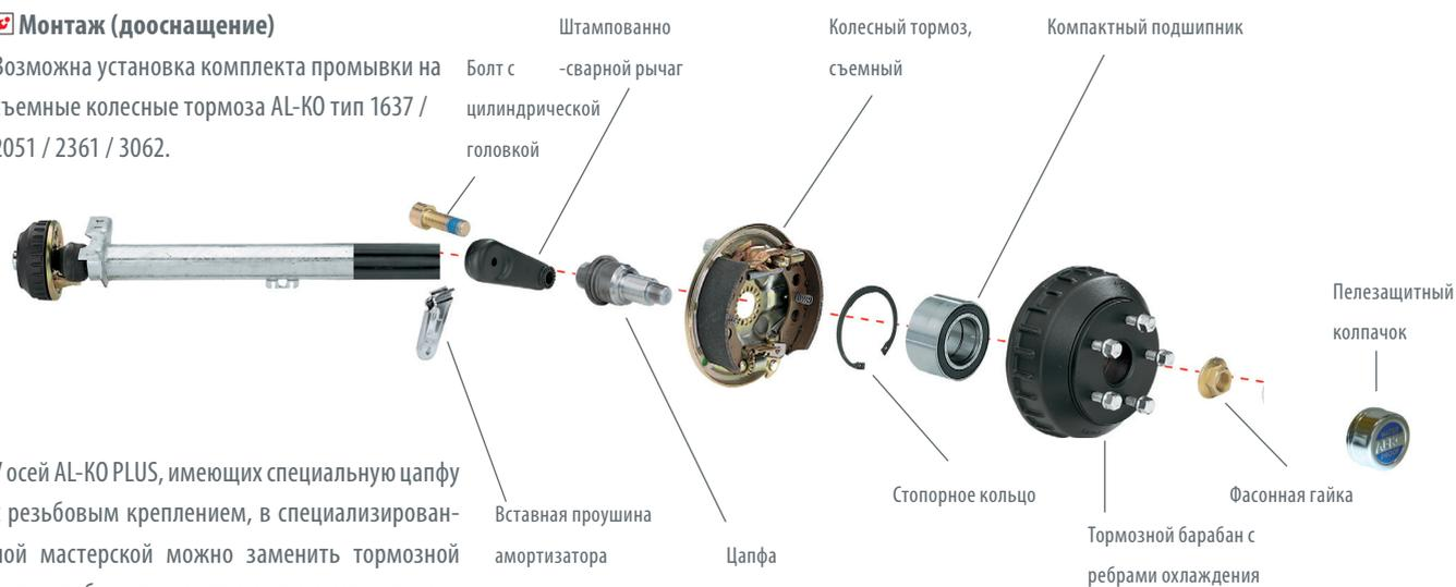
У осей AL-KO PLUS, имеющих специальную цапфу с резьбовым креплением, в специализированной мастерской можно заменить тормозной щит, чтобы впоследствии доукомплектовать ось системой промывки колесных тормозов.
