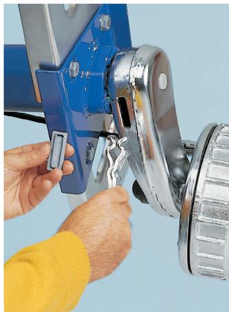
Вставная проушина для крепления амортизатора.
