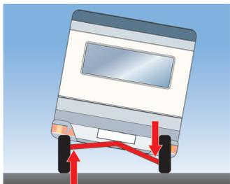
Конструкция изогнутой оси AL-KO Delta с направленными к центру рычагами противодействует центробежной силе. Верхняя точка более нагруженного внешнего колеса поднимаясь выше, вместе с тем сильнее наклоняется к центру.
